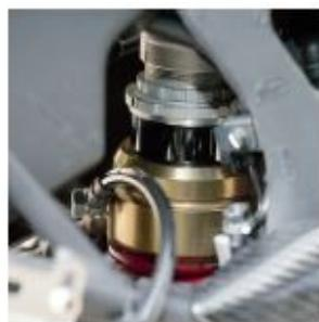
**QUI ACCANTO,** il serbatoio della molla ad aria. L'immagine più a destra, invece, mostra il sistema completo: sopra alla molla elicoidale c'è l'anello che contiene l'olio, che a sua volta, quando compresso, spinge un pistone dentro al serbatoio.
